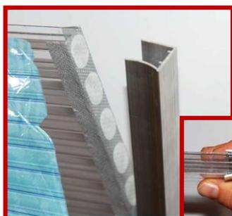
Montieren Sie dann an der Unterseite (Traufe) die Alu-U-Abschlussprofile mit Tropfnase nach unten. Die Schutzfolie wird dabei nur soweit entfernt wie es zur Befestigung nötig ist. Die gekennzeichneten Schutzfolien müssen nach außen gerichtet sein - UV-Schutz!
